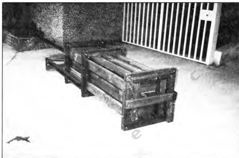
Foto 1: La máquina Enfardadora da abasto suficiente para 5 hectáreas de alfalfa en un turno. Su diseño es desarmable y consta de 4 piezas.
